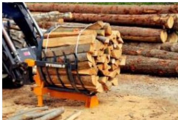
Slika 12: Povezovalnik drv Vir: http://www.uniforest.si/python_f.php
