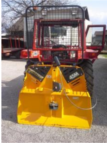
Slika 3 Traktorska vitla – tritočkovni priklop
