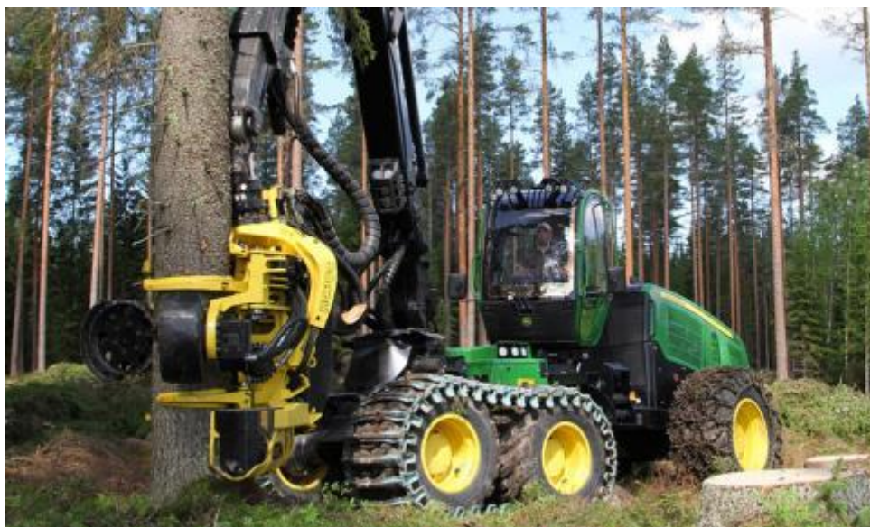
Slika 2: Stroj z napravo objame drevesno deblo in ga odreže
